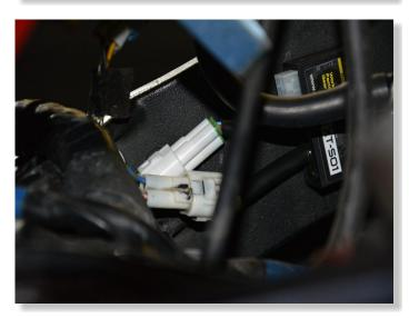
PLUG X-TRE CONNECTORS IN-LINE WITH THE GEAR POSITION SENSOR CONNECTORS.
