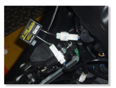
PLUG X-TRE CONNECTORS IN-LINE WITH THE GEAR POSITION SENSOR CONNECTORS. (WHITE, 3-POLE TRIANGULAR CONNECTORS BELOW THE FUEL TANK AT LEFT SIDE)
