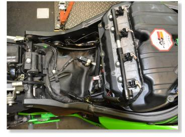
UNPLUG THE GPS CONNECTOR. (BLACK, 6-POLE CONNECTORS BELOW THE FUEL TANK AT RIGHT SIDE)
