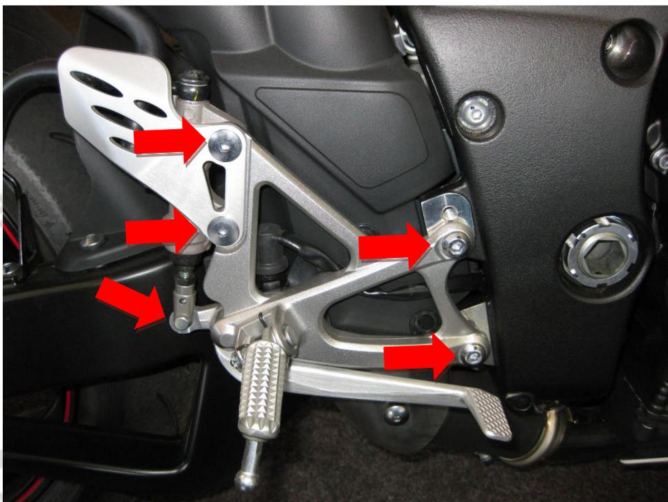
Connecter le cylindre de frein avec l'adaptateur cylindre de frein R&G, trouver la bonne position pour les trains arriere et les connecter au cadre.
