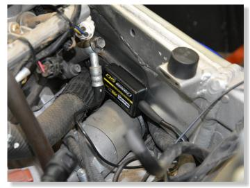
CONNECT QSX BLACK WIRE TERMINAL TO CHASSIS GROUND.
