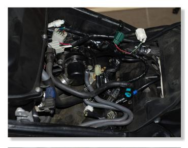
PLUG GPX CONNECTORS IN-LINE
