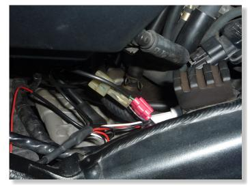
CONNECT GPX RED WIRE TO BROWN WIRE OF REAR BRAKELIGHT SWITCH CONNECTOR.
