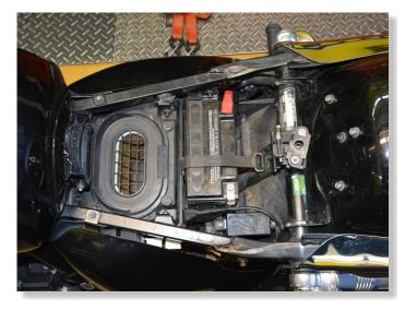
REMOVE THE INTAKE/SIDE COVER FROM LEFT SIDE.
