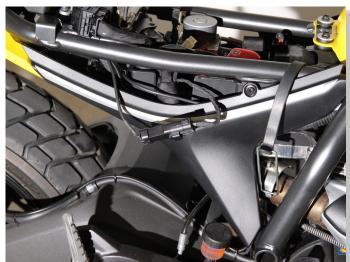
CONNECT THE GPDS RED WIRE TO WHITE WIRE OF REAR BRAKE LIGHT SWITCH CONNECTOR.
