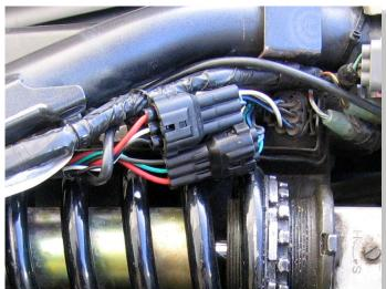
CONNECT ATRE RED WIRE TO BROWN WIRE OF REAR BRAKE LIGHT SWITCH CONNECTOR.
