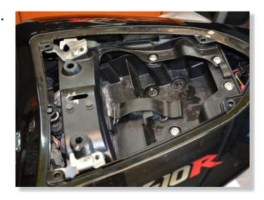
LOCATE THE REAR LIGHT CONNECTOR UNDER PASSENGER SEAT NEAR REAR LIGHT.
