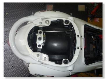
LOCATE THE REAR LIGHT CONNECTOR UNDER PASSANGER SEAT NEAR REAR LIGHT.
